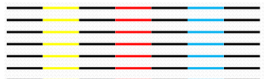
图 8.12 水平喷头对齐测试条
