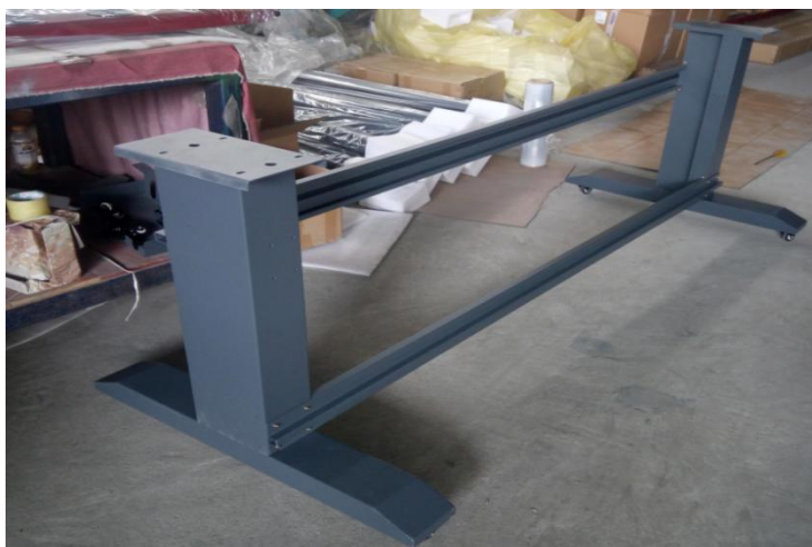
图 1.9 机脚、机脚底板与方型横梁安装完成示例图（五）
