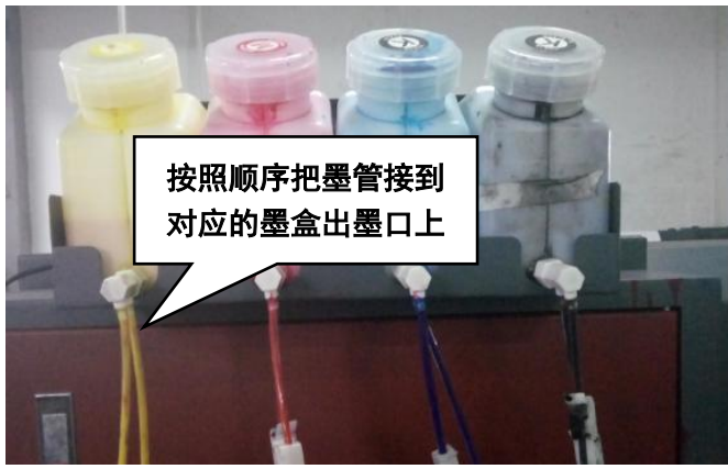
图 5.4 设置墨序与安装墨管
