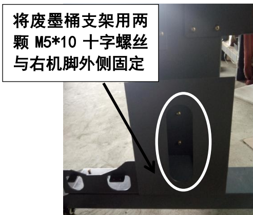
图 1.16 废墨桶支架安装示意图
