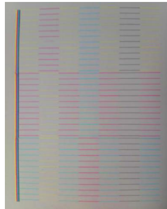
图 8.12 水平喷头对齐测试条
